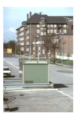
Dieselruß, NO, NO2 und CO gemessen. An insgesamt drei Messstationen werden die meteorologischen Komponenten Windrichtung, Windgeschwindigkeit, relative Feuchte und Temperatur erfasst. Auf dem Dach des Fachamtes Umweltuntersuchungen der Umweltbehörde werden außerdem Niederschlag und Globalstrahlung gemessen.
