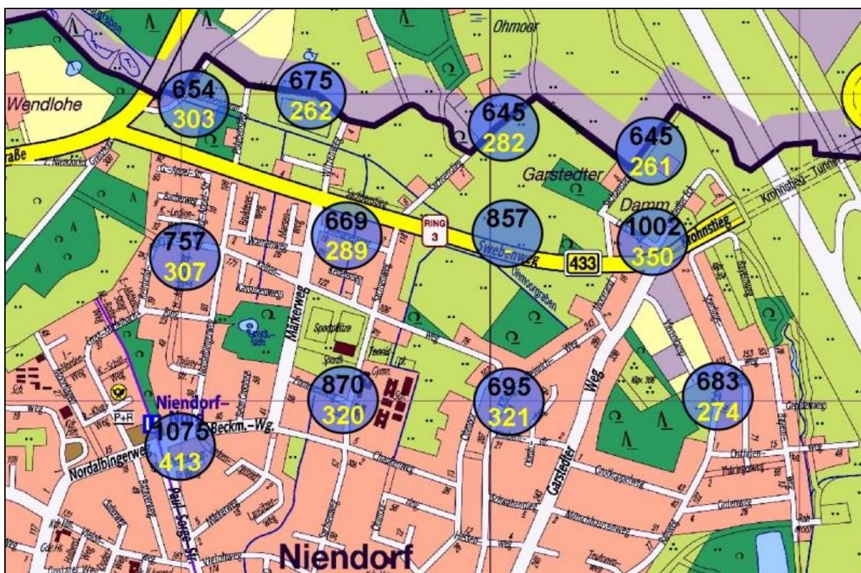
Abb. 10: Die mittlere CO-Belastungen an den 11 Messpunkten in Niendorf-Nord in den Jahren 1994/95 (oben) und 2005/06 (unten)
