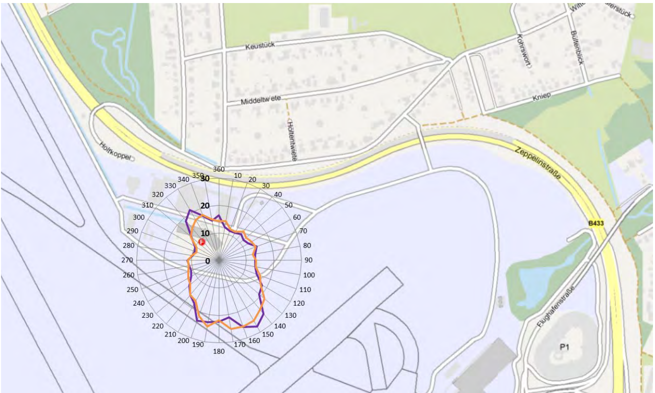
Abbildung 19: Konzentrationsrosen für Stickstoffdioxid (NO 2 ). Lila aus dem Jahr 2021, orange aus dem Jahr 2020.
